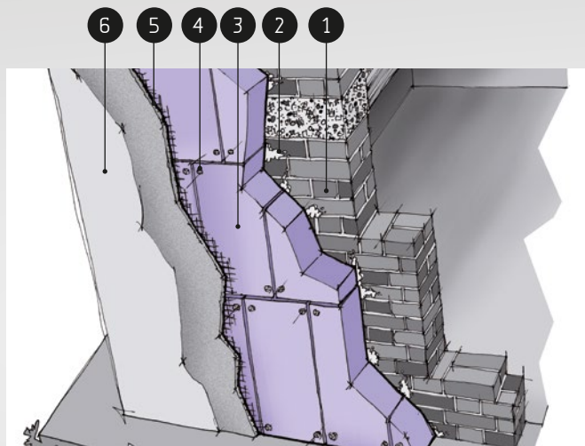
1. MURATURA / 2. COLLANTE CEMENTIZIO / 3. X-FOAM 4. TASSELLI DA CAPPOTTO / 5. RASATURA ARMATA / 6. FINITURA
