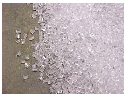
Cristalli di polistirene prima dell'espansione ed estrusione
